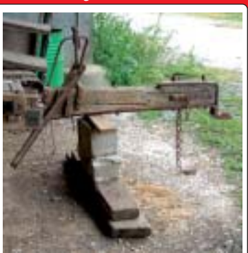
Matériel mal stabilisé au remisage
